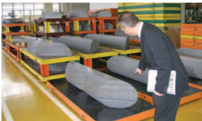
Jedra različnih transformatorjev so sestavljena iz natančno odrezane magnetno orientirane pločevine
