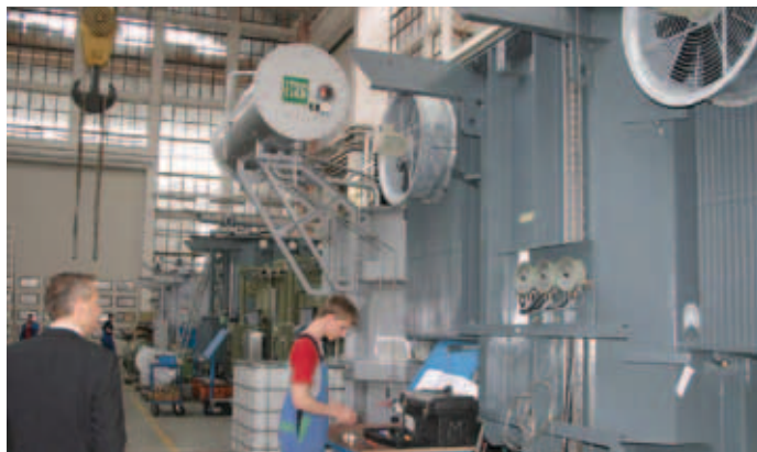
Končna montaža transformatorjev
